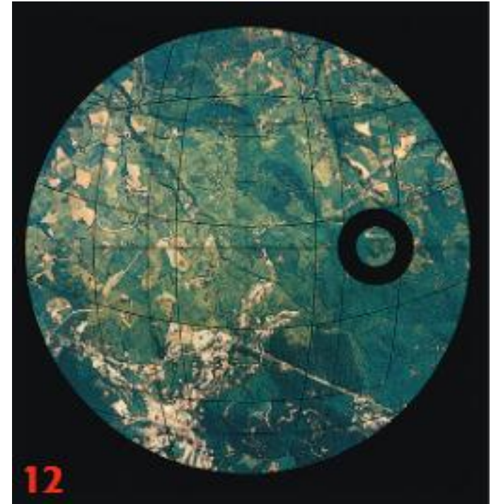
FIGURA 12 Aspetto del visore del periscopio di navigazione con il reticolo del cinederivometro e l'immagine della livella sferica della camera.
