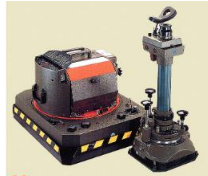
FIGURA 11 Camera aerea Wild RC30; in primo piano il periscopio di navigazione con incorporato il cinderivometro. La parte inferiore rettangolare della camera rimane fissa alla fusoliera; a quella superiore, che contiene la lastra, possono essere impresse rotazioni per eliminare gli effetti della deriva.
