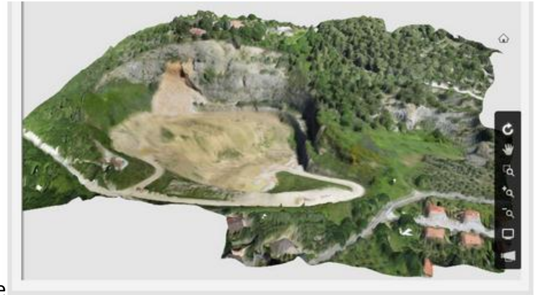
Modello 3D di una cava restituito da foto digitali da drone grazie a Recap Photo, 2013
